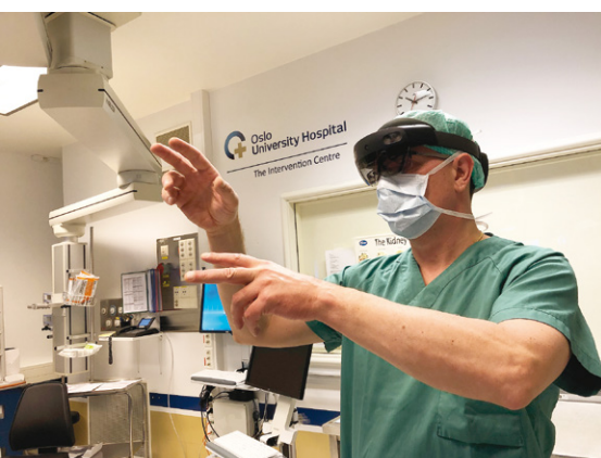
Slika 2: Microsoft® HoloLens je prenosna naprava, ki omogoča uporabo mešane resničnosti. Natakemo si jo na glavo kot nosljiv zaslon in v 3D-okolju raziskujemo pacientov organ, načrtujemo operacijo, razpravljamo z asistenti in jo seveda lahko uporabljamo tudi v učne namene. Vir, z dovoljenjem: E. Pelanis (2).
