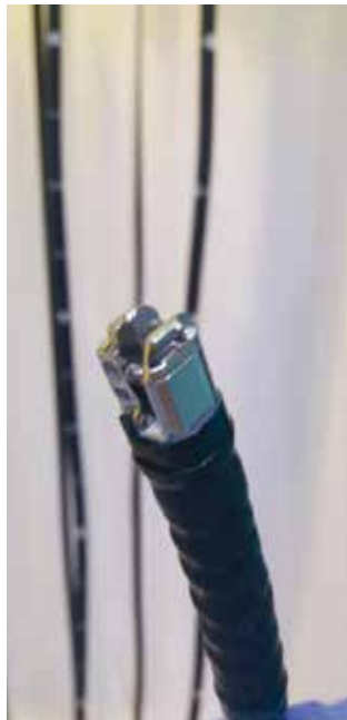
Klasični duodenoskopi imajo Albarranov mehanizem odstranljive distalne kapice, ki omogoča čiščenje in dezinfekcijo.
