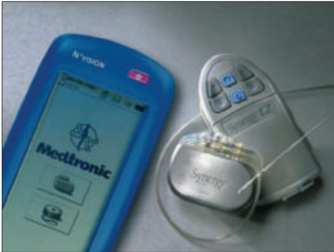
Komplet za stimulacijo hrbtenjače: zunanji programator (levo), baterija in elektrode (sredina) in daljinski upravljalnik za bolnika (desno).
