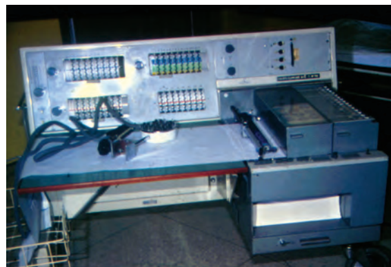
32-kanalni EEG-aparat iz začetka sedemdesetih let. EEG, odkrit leta 1929, je bil prva metoda, ki je omogočala spremljanje električne aktivnosti centralnega živčevja (fotoarhiv Nevrološke klinike UKCL).
